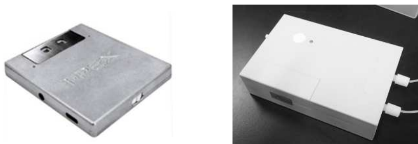
図1 ニオイセンサ 左：nose@MEMS（センサ A） 右：MSS（センサ B）
